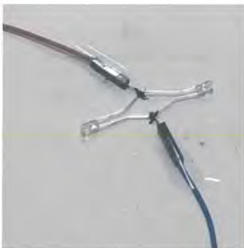
图 5-24 将 LED 灯并联，利用导电墨水冷焊固定
