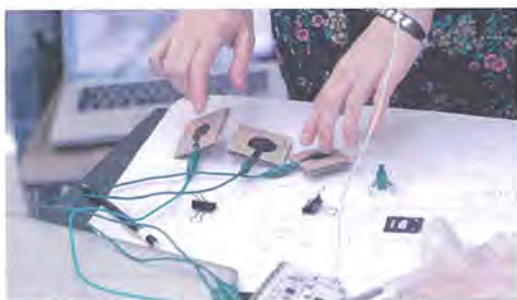
图 5-11 导电墨水作为传感器
